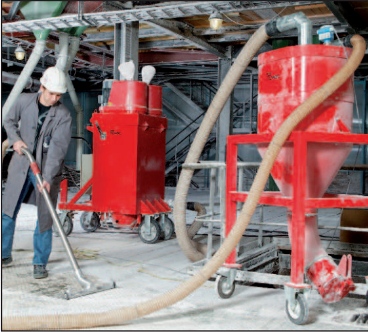
Séparateur 200 l sur châssis autonome et mobile
