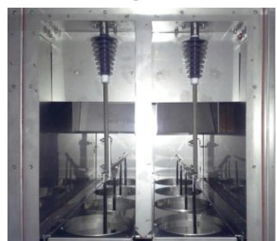
Électrodes d'un électrofiltre OekoRona
