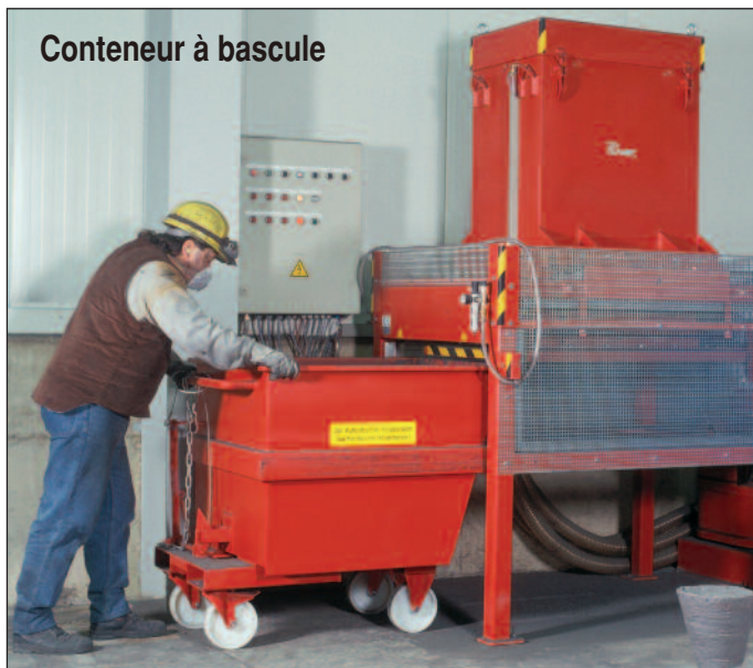
Chariot équipé d'un dispositif à bascule
