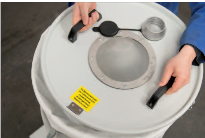
Remplacement du filtre par simple levage du couvercle
